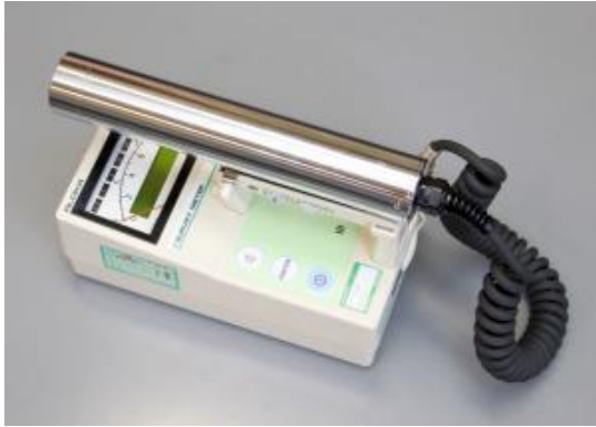
三鷹市が購入した放射線量測定器 日立アロカメディカル社 TCS-172B
